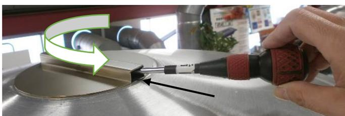
ネジが固い、途中で固着した場合等はこの隙間から中心のネジ部分に向かってスプレー油等を吹き付けてください。
